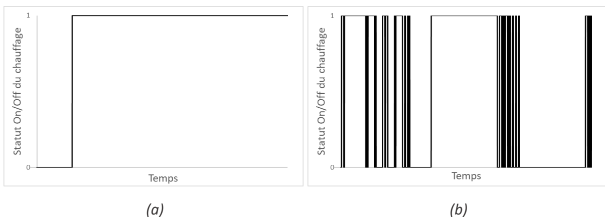
(a) (b) Figure 2.9 : Statut du chauffage en fonction du type d'essais : (a) Step, (b) ROLBS
