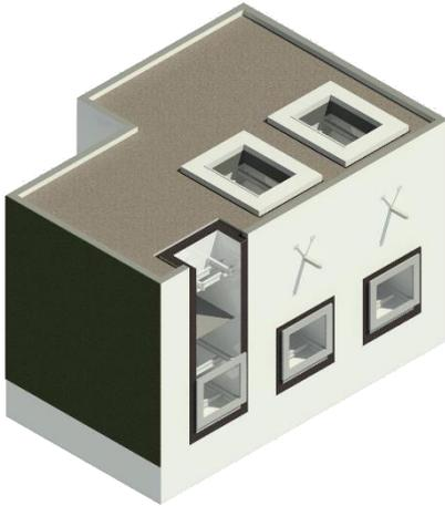
Cet équipement est doté de **5 cellules indépendantes** permettant de reproduire l'environnement intérieur d'une pièce de bâtiment. L'ambiance intérieure est régulée en température par des systèmes dédiés (entre 15 et 40°C).
